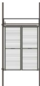
Mechaniczne drzwiczki dokujące - Brak możliwości otwarcia jeśli klatka nie znajduje się na poziomie piętra
